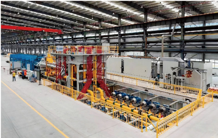
5500吨双动铜挤压机 国内同行业最大双动铜挤压机之一
